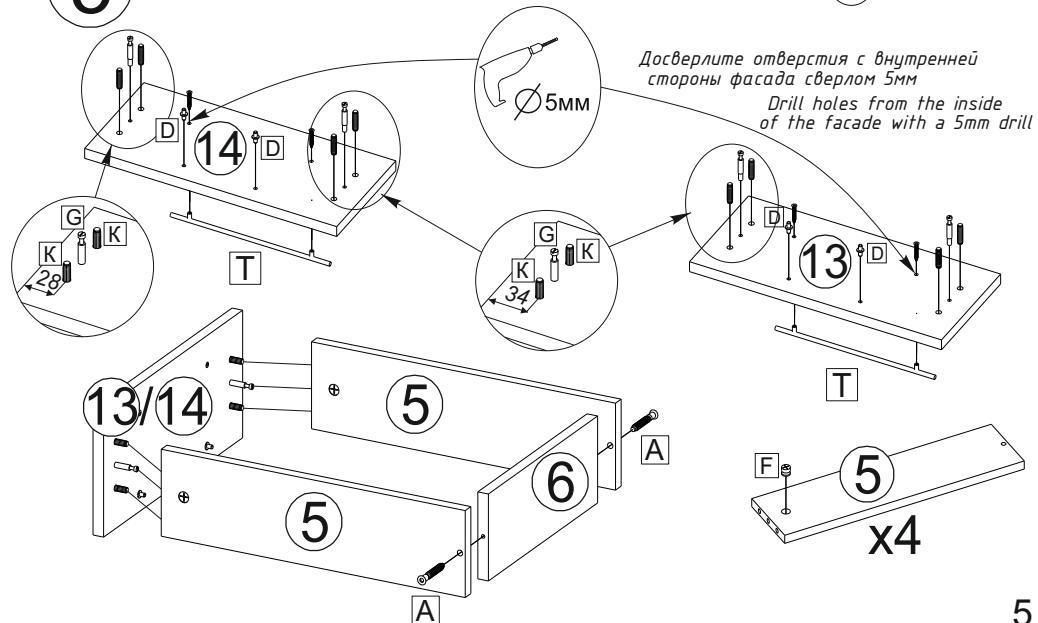
Досверлите отверстия с внутренней стороны фасада сверлом 5мм
