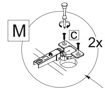
Досверлите отверстия с внутренней стороны фасада сверлом 5мм
