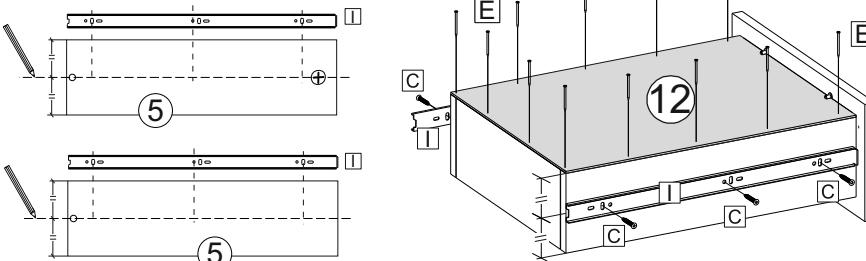
Отметьте середину на боковине ящика и прикрутите внутреннюю планку направляющей строго по отмеченной середине
