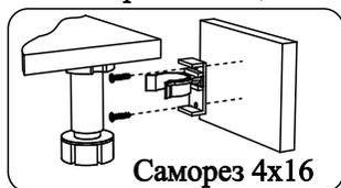
схема монтажа опоры
