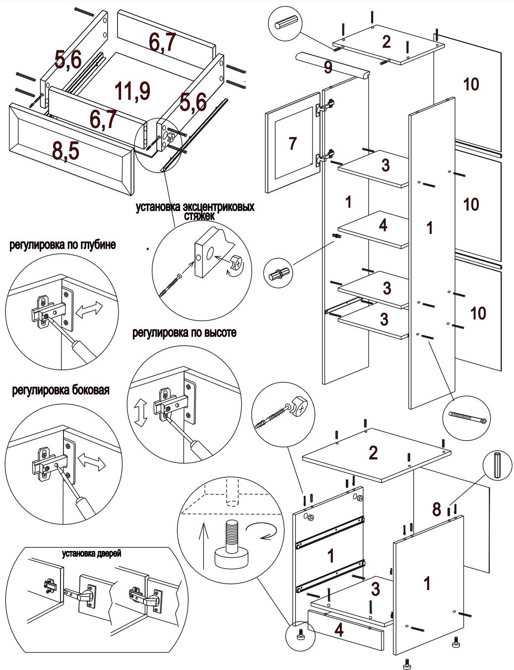
Гвозди 2\*25 используются для крепления ДВП, саморезами 4\*16 крепятся петли. Если несколько модулей устанавливаются рядом, их необходимо стянуть между собой межсекционными стяжками 25 мм, просверлив самостоятельно отверстия диаметром 5 мм в произвольных местах. Фасад №7 изготовлен универсально в лево/право, отверстия под ручку досверлить самостоятельно.
