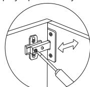
Гвозди 2\*25 используются для крепления ДВП, саморезами 4\*16 крепятся петли. . Если несколько модулей устанавливаются рядом, их необходимо стянуть между собой межсекционными стяжками 25 мм, просверлив самостоятельно отверстия диаметром 5 мм в произвольных местах.
